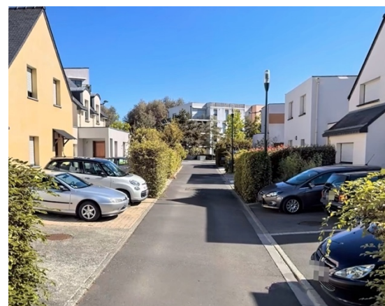
Exemple de voie de desserte apaisée pour l'accès aux habitations : un profil étroit, un encadrement par la végétation pour occulter les espaces de stationnement et un traitement au sol spécifique
